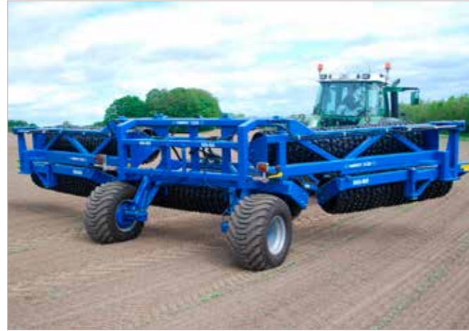
Nejdříve se provede zvednutí z automatické přepravní polohy a následně vyklopení - rozložení vnitřních bočních sekcí.
