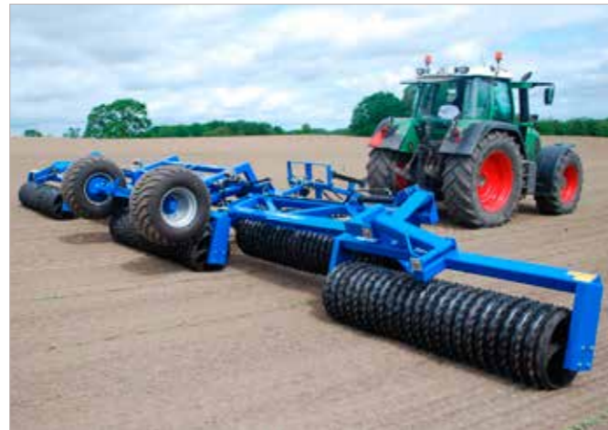
Po úplném rozložení se válce položí na zem a podvozek s pneu se zvedne od země.
