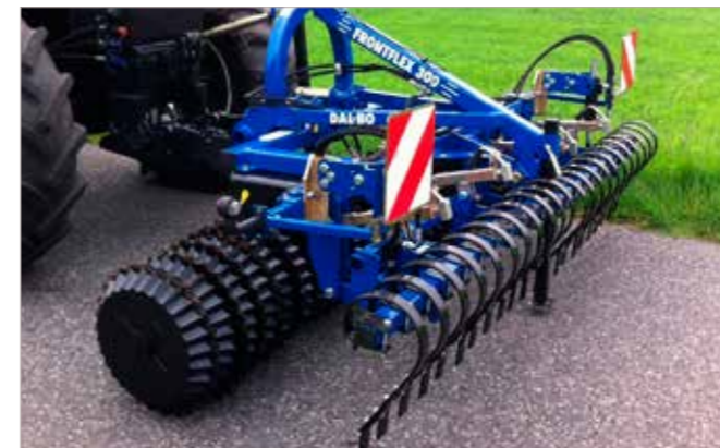
Hydraulicky ovládaná smyková lišta Crackerboard
