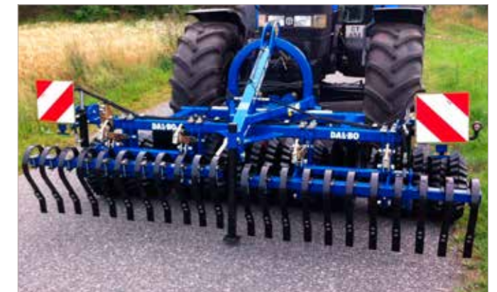
Hydraulicky ovládaná smyková lišta Crackerboard
