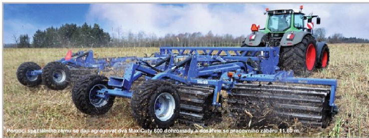
Pomocí speciálního rámu se dají agregovat dva MaxiCut 600 dohromady a dosáhně se pracovního záběru 11,60 m.
