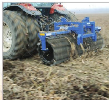
MaxiCut 150 – 300 je možné agregovat do předního i zadního třibodového závěsu.
