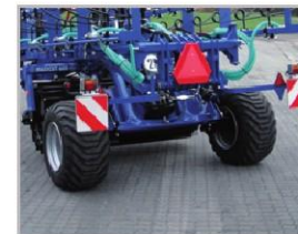
MaxiCut je standardně dodáván s pneu o rozměru 400/60x15.5 TWIN. Volitelně lze zvolit pneumatiky o rozměru 480/45x17 TWIN a lze dodat i vzduchové brzdy.
