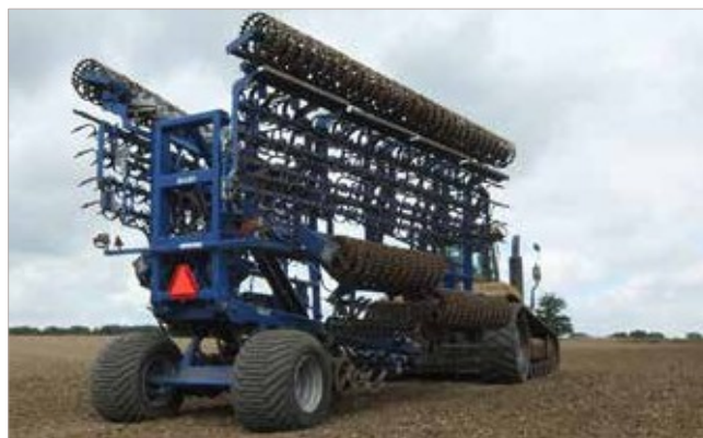
... Stroj opět složený na přepravní šířku 3 m.
