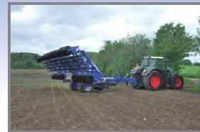
Stroj je spuštěn na zem přes kolový podvozek, poté se natlačuje hydraulikou dotáhování postranních sekcí a práce může začít.
