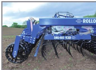
Při rozkládání se nejprve zvednou boční sekce z transportních zámků.
