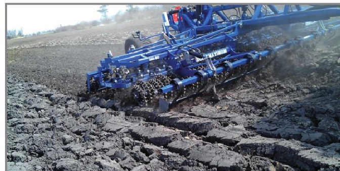
Stroj je spuštěn na zem přes kolový podvozek, poté se natlačuje hydraulikou dotáhování postranních sekcí a práce může začít.
