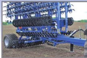
Při rozkládání se nejprve zvednou boční sekce z transportních zámků.
