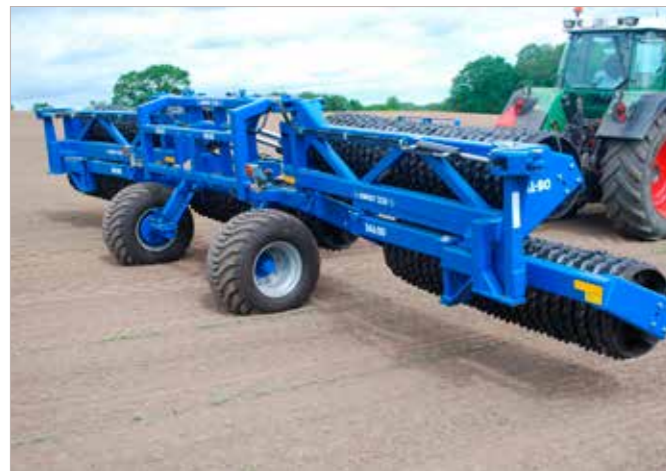
Následně se rozloží vnější boční sekce pomocí promyšleného systému otočné kulisy.
