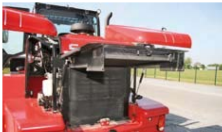
Po vyklopení chladiče klimatizační jednotky je přístupný hlavní chladič.
